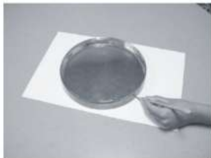
1. ábra. A főtükör körvonalának megrajzolása.
