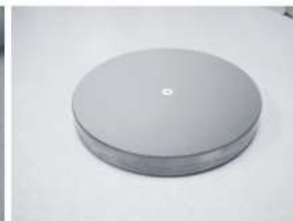
6. ábra. A központi jellel ellátott főtükör.
